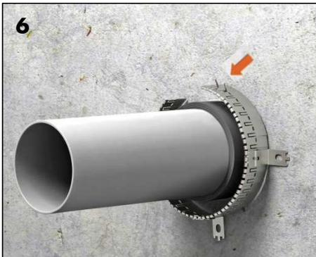
**6** Piegate di 90° verso l'esterno le ultime due linguette di uno degli estremi del nastro metallico, dunque avvolgerlo intorno al nastro intumescente. Far passare le due linguette piegate attraverso due fori dell'altro estremo del nastro metallico che andrà a sovrapporsi, quindi ripiegare nuovamente le due linguette di 90° verso l'interno in modo tale da fissare saldamente il nastro stesso intorno al nastro intumescente.
