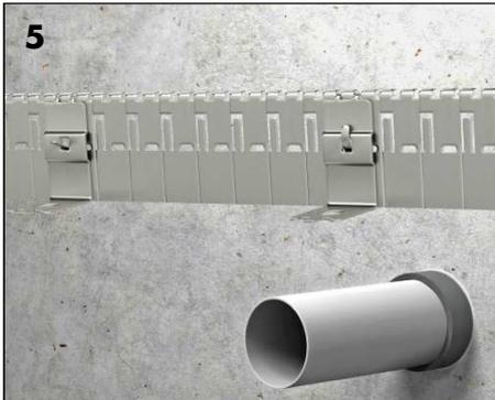
**5** In corrispondenza delle linguette del nastro precedentemente piegate, inserire l'asola dei ganci metallici negli appositi denti ripiegati presenti lungo uno dei due bordi del nastro metallico. Far passare quindi la linguetta piegata del nastro attraverso l'apposito foro al centro del gancio metallico, dunque fissare il gancio al nastro ripiegando nuovamente la linguetta di 90° verso l'interno. Ripetere l'operazione in tutti i punti di fissaggio del collare alla parete o al solaio.
