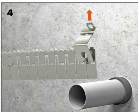
Inserire la punta del gancio metallico nell'apposito spazio sopra alla linguetta presente al centro del nastro metallico, per aiutarsi a piegare la linguetta di 90° verso l'esterno. Ripetere l'operazione nei punti che diventeranno poi i punti di fissaggio del collare alla parete o al solaio, il cui numero varia a seconda del diametro esterno del tubo e della linearità o meno del tubo (vedere tabella specifica "Quantità min. di ganci metallici" presente all'interno della Tabella 5 o 6).
